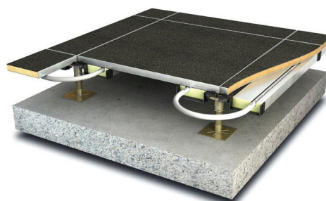
Σχήμα 1 - Συστατικά μέρη ενός υπερυψωμένου δαπέδου
