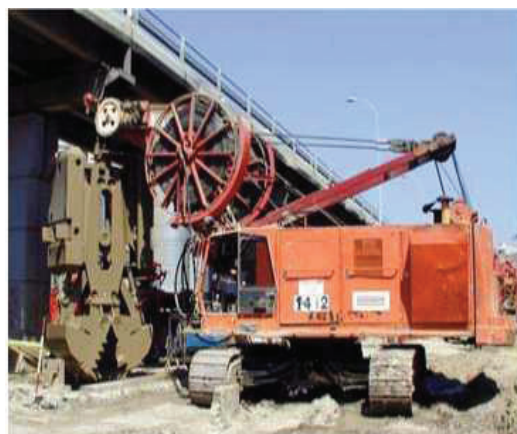
Εικόνα 3 - Αρπάγες μηχανικής λειτουργίας με συρματόσχοινο (μπένες)
